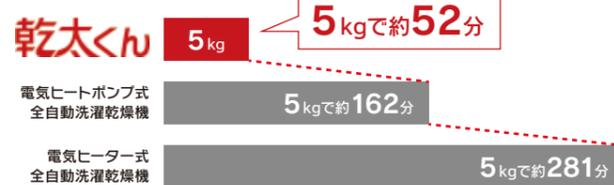
■ガス衣類乾燥機(乾太くん):リンナイ、電気ヒートポンプ式乾燥、電気ヒーター式乾燥 試験実施・リンナイ(株)
